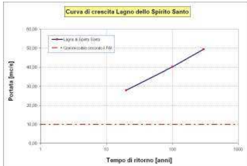
Figura 54. Lagno di Spirito Santo. Curva di crescita delle portate con valori tratti dal PAI.
